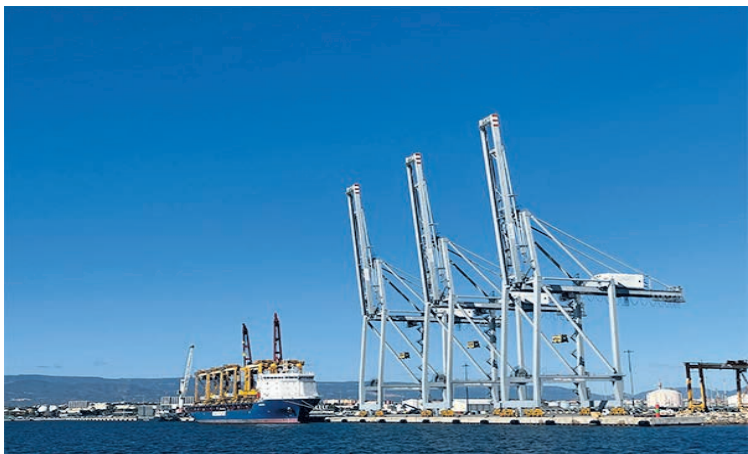
Super Post Panamax STS. Llegadas desde Tarragona a Guixar en 2016 pesan cada una 40 toneladas. TRANSPORTE XXI
